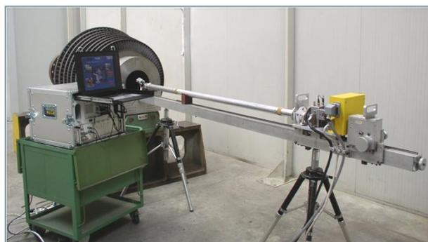
**La soluzione** La soluzione adottata – dal punto di vista dell'acquisizione e controllo - un sistema di acquisizione e generazione dati PXI di National Instruments, ed integra due elettroniche custom per il condizionamento del segnale delle sonde ultrasoniche e per la gestione dei motori di avanzamento delle sonde. Due applicativi realizzati in ambiente LabVIEW consentono la gestione del sistema e l'analisi off-line dei dati acquisiti.
