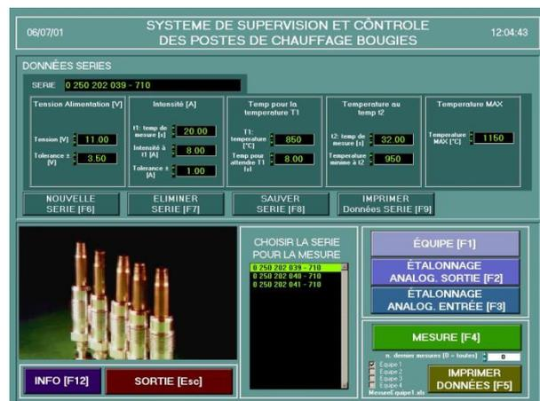
**Introduzione** Il programma di collaudo ha come scopo quello di gestire la stazione di collaudo sulla linea di assemblaggio. Il programma consente la taratura delle dieci teste di misura, che lavorano altrettante candele simultaneamente, ed il salvataggio dei dati e curve effettuate durante il collaudo. I dati e le curve così ottenute per ogni "testa" vengono rappresentati su apposito pannello, salvati su disco fisso e possono essere stampati sulla stampante di sistema.
